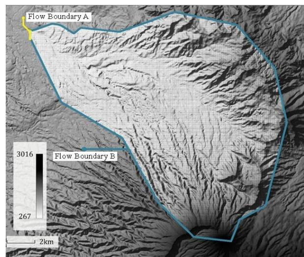
**Slika 6:** Nastavitev računalniške domene za HEC-RAS.
