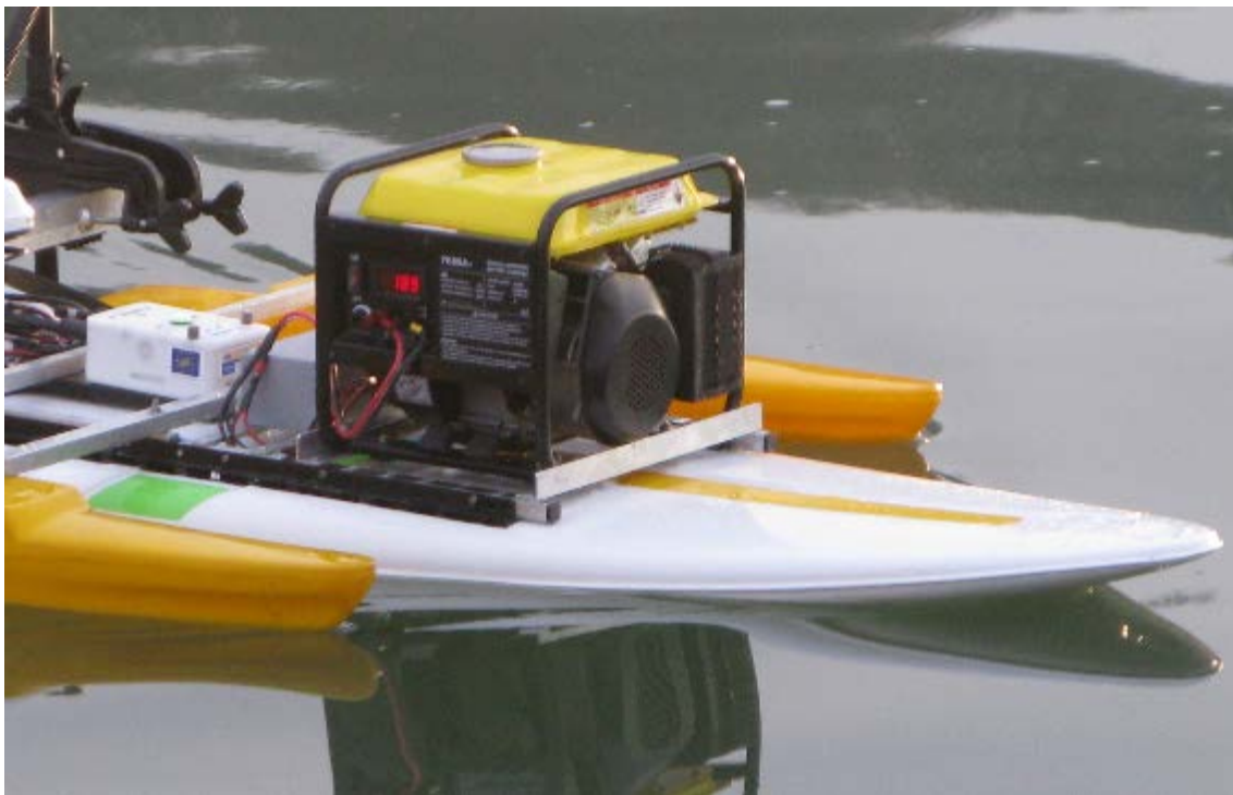
Slika 4: Napajanje čolna preko električnega agregata.
