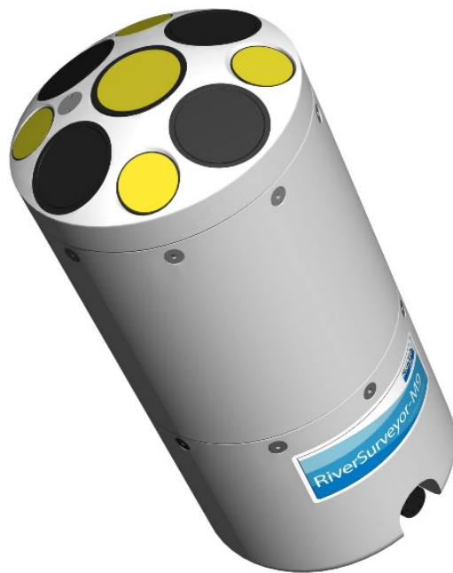
Slika 3: Merilni instrument SonTek RiverSurveyor M9 ADP (vir: sontek.com).
