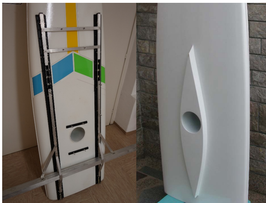
Slika 2: Nosilne sani (levo) in kobilica na dnu čolna (desno).
